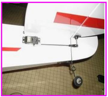
Install the elevator servo.
